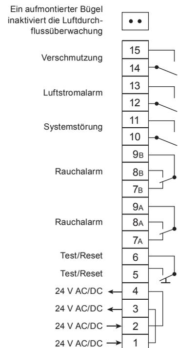
Die Relaisausgänge werden im ausgeschalteten/Alarm-Modus angezeigt.
